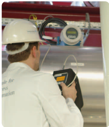
Obr. 1 Verifikácia a diagnostika – možnosť overenia funkčnosti a stavu zariadenia bez nutnosti jeho demontáže
